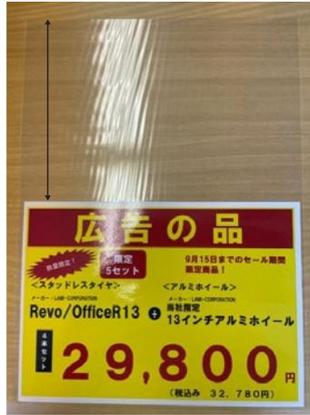
加工物の先端側・後端側の余白を 1mm 単位で設定できます。掲載時、資料に穴を開けずに掲載できます。
